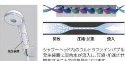
シャワーヘッド内のウルトラファインバブル発生装置に混合水が流入し、圧縮・加速させ開放することで泡を発生させます。
